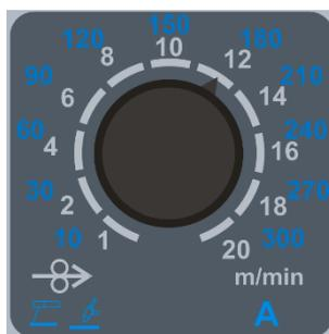
Der Drahtvorschubgeschwindigkeit kann mit einem Potentiometer im Bereich von 1,0 m/min bis 20,0 m/min eingestellt werden. Die Schweißspannung kann in 12 Stufen gemäß folgender Tabelle eingestellt werden:
