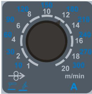
Der Schweißstrom kann im Bereich von 10 Ampere bis 300 Ampere eingestellt werden
