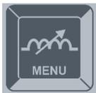
Es besteht die Möglichkeit, die voreingestellte elektronische Induktivität der Stromquelle zu korrigieren. Ein kurzer Druck auf die MENU-Taste aktiviert die Dynamikeinstellung.
