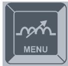
Halten Sie die MENU-Taste gedrückt, während Sie den Hauptschalter einschalten, bis der Startvorgang beendet ist, um das erweiterte Menü zu aktivieren. Nach diesem Vorgang ist das erweiterte Menü durch kurzes Drücken der Menütaste verfügbar, bis die Maschine wieder ausgeschaltet wird.
