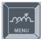
Wenn die Dynamic/Menu Taste kurz gedrückt wird, können grundlegende Menüparameter durch Drehen des Lichtbogenlängen Encoder aufgerufen werden.
